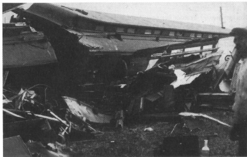
Ved afsporingen blev de bagerste vogne presset frem, så de mellemliggende 3 trævogne blev splintret. Da afsporingen var slut stod vogn nr. 7 ved vogn nr. 3.
